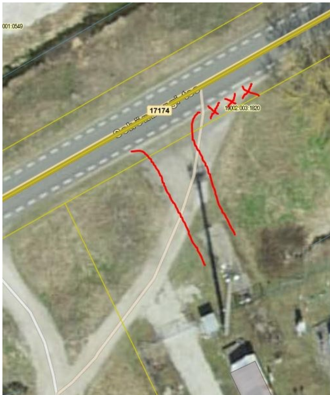
Joonis 1. Riigitee ristumiskoha remont (x tähistatud taastatav teepeenar), skeem Maa-ameti geoportaali väljavõttel
